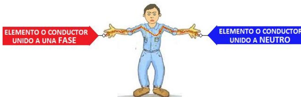
Figura 1) Imagen de una persona sufriendo un contacto directo entre Fase y Neutro (normalmente 230 V), siendo destacable que ningún medio de protección actual puede evitar este accidente eléctrico.
